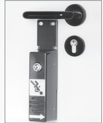
Mit dem Geräteschlüssel kann der Türwächter durch Drehung um 180° alarmfrei in eine Dauerfreigabeposition gebracht werden. In dieser Stellung ist die Tür normal zu begehen.
