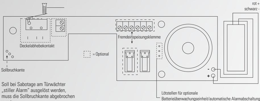
Soll bei Sabotage am Türwächter „stiller Alarm“ ausgelöst werden, muss die Sollbruchkante abgebrochen werden.
